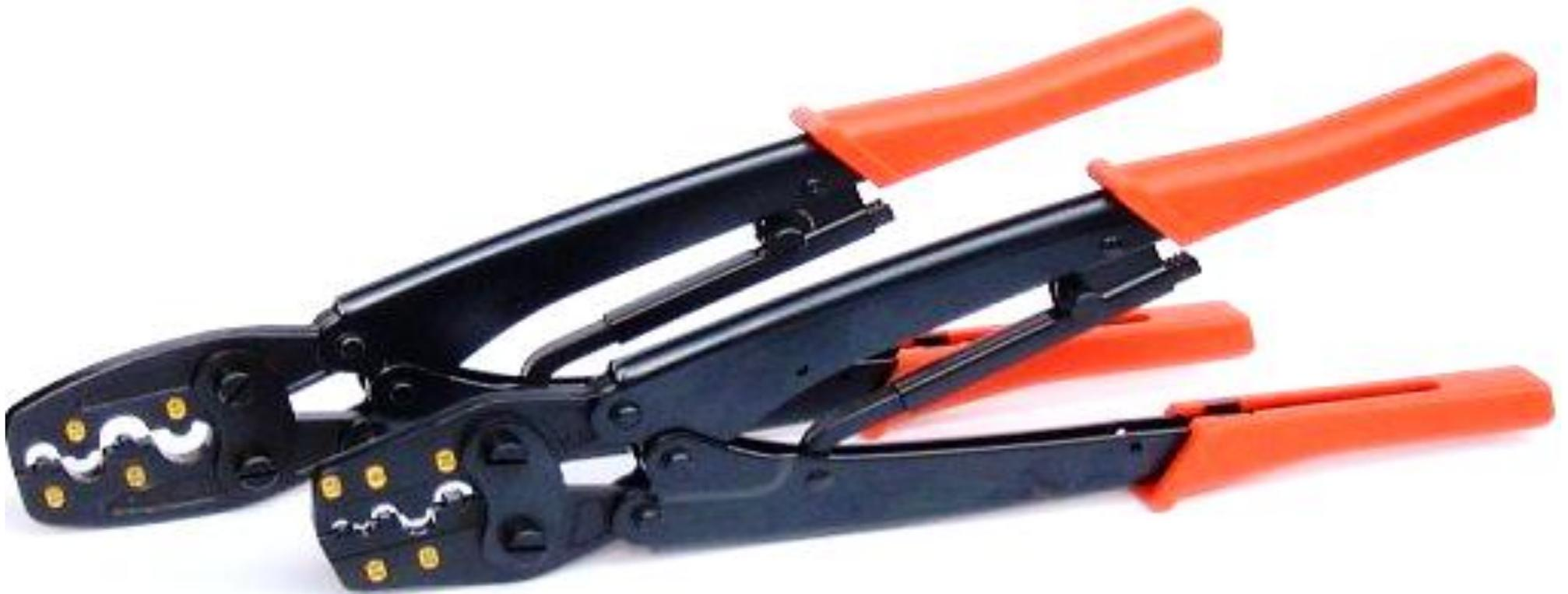
**Crimpzange für unisolierte Flachsteckhülsen
